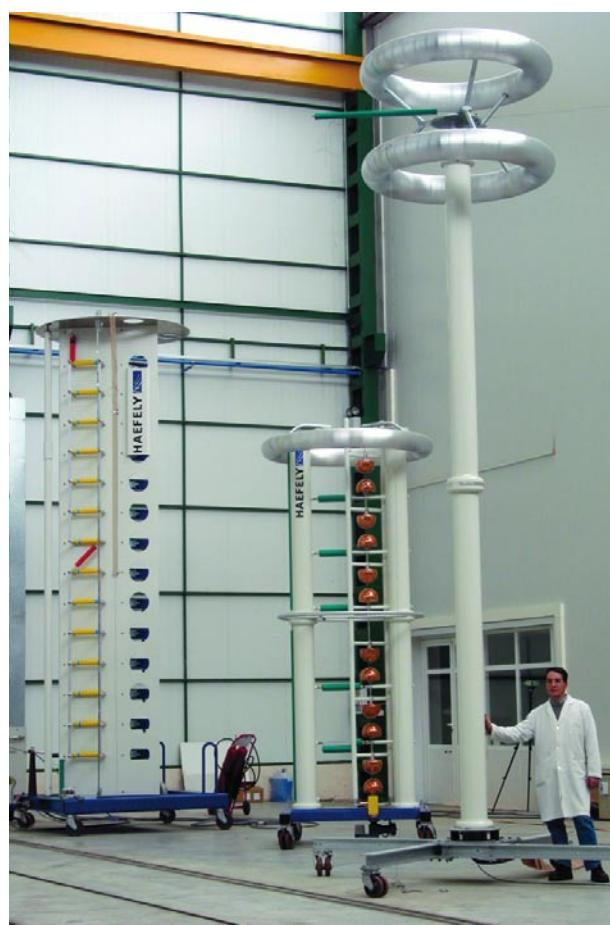
Лаборатория для испытания грозовым импульсом
