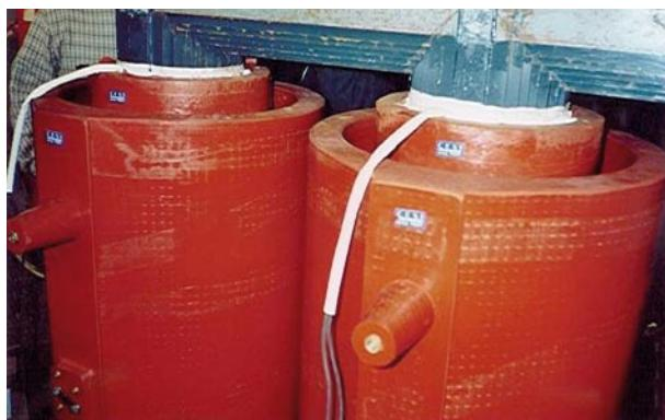
Наши трансформаторы после прохождения испытания на соответствие классу E2.
