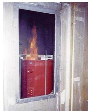
Наши трансформаторы в период прохождения испытания на соответствие классу F1.
