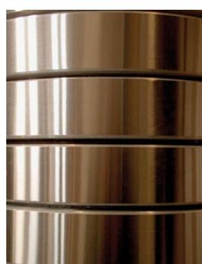
Данная конструктивная особенность, а именно: изготовление обмотки СН из алюминиевых ленточных полос и обмотки ВН из единого алюминиевого листа позволяет повысить устойчивость к осевым нагрузкам, возникающим из-за короткого замыкания.
