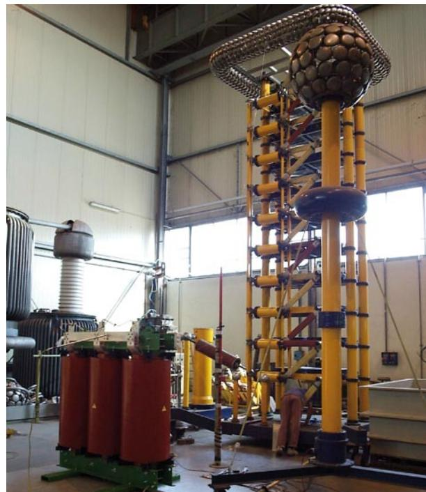
Испытание атмосферным импульсом в лабораториях CESI в Милане
