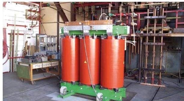
Испытание на сопротивление короткому замыканию в лабораториях CESI в Милане
